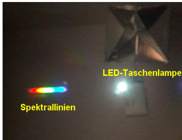
Schnellversuch im GEP-Büro an einer kleinen LED-Taschenlampe und einem vor das Handyobjektiv gehaltenen Beugungsgitter
